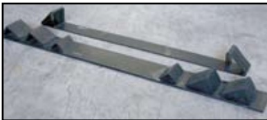
Bastidores para bobinas y almohadillas de caucho (camiones de plataforma)
